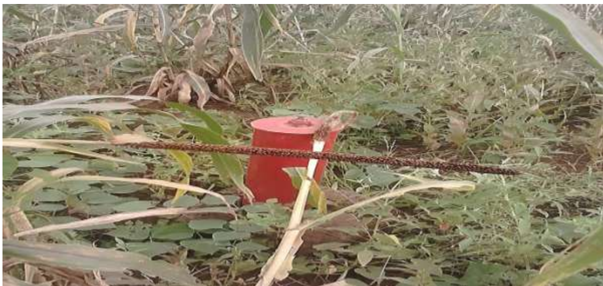
Photo : pompe de mesure du niveau de la nappe phréatique sur le site de Sabara
