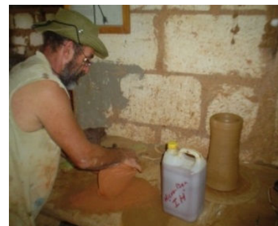
Fabrication de filtres céramiques avec des EM, Cuba (Blanco, 2012)
