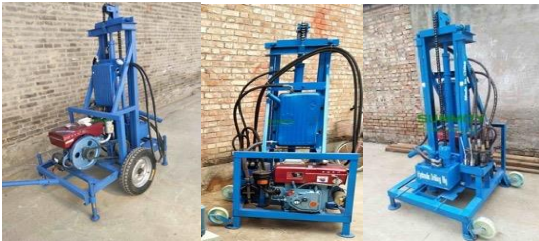
Image 8 : Vues de la tarière thermique sur plateforme mobile
