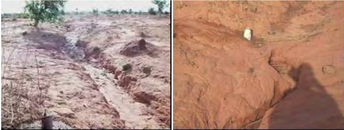
Photo 77: Suivis de l'érosion régressive des ravines secondaires à l'aide de piquets repères dans le bassin versant du kori Boubon en 2007 -2008 et 2009
