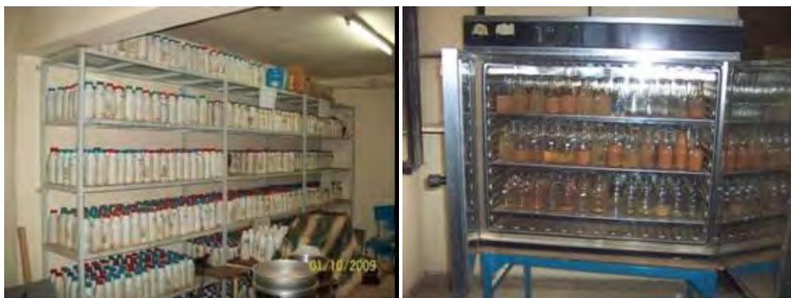
Photo 10: Echantillons prélevés et en cours de traitement par décantation et évaporation à l'étuve au laboratoire du département de Géographie à Niamey en octobre 2009
