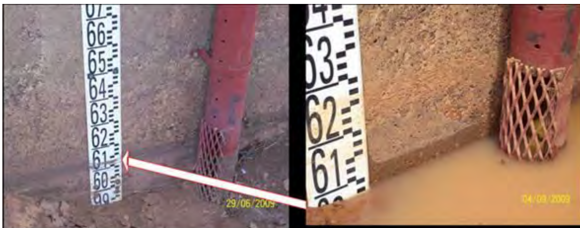
Photo 93: Deux photos prises successivement le 29 juin 2009 (niveau à 608 cm de l'échelle et le 4 septembre 2009 (niveau sable à la cote 615 cm de l'échelle)
