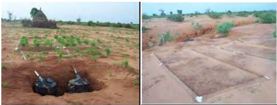
Photo 8: Des parcelles d'érosion sur un versant du bassin Boubon en juillet 2008 : 2 répétitions sur mil et sur croûte d'érosion.
