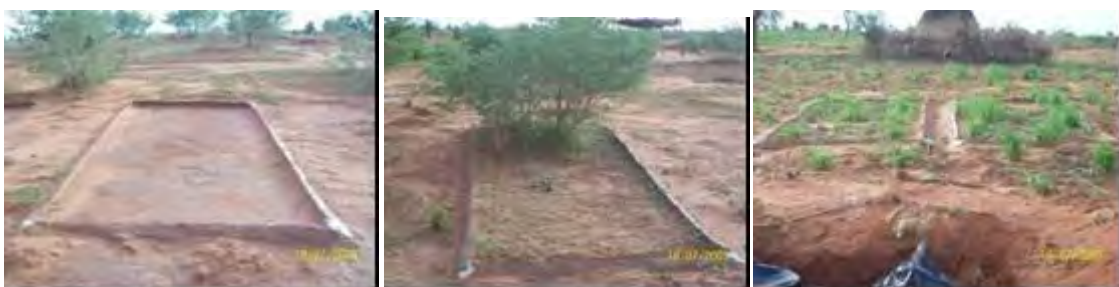
Photo 73: Parcelle de mesure d'érosion sur un état de surface de croûte d'érosion dans le bassin versant du kori Boubon
