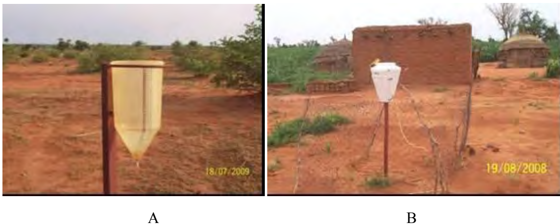
Photo 6: Pluviomètre à lecture directe installé à mi-bassin du kori Boubon et Pluviomètre enregistreur installé en aval du kori Boubon
