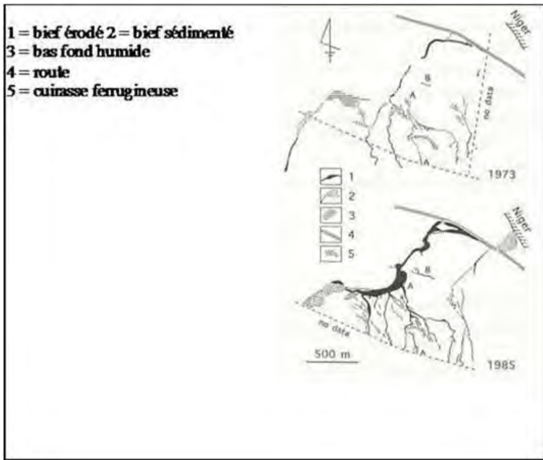
Figure 14: Accélération du ravinement des versants et de l'ensablement des bas fonds entre 1973 et 1985 sur la rive droite du fleuve Niger dans la région de Niamey (d'après Chinen, 1999)
