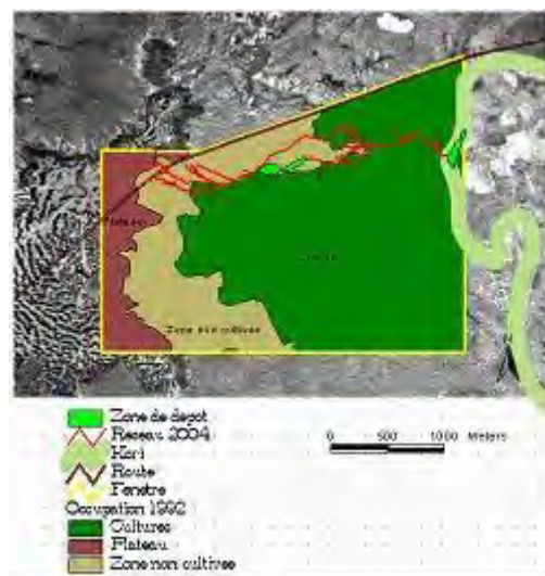
Figure 4: En rouge le réseau de ravines en 1950 et 2004 sur le versant du bassin de Wankama (Le-Breton 2004)
