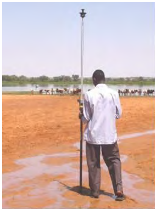
Photo 15: Levé topographique continu pour la production d'un MNT de début de campagne sur le cône d'épandage du kori Gorou Kirey
