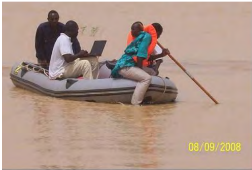
Photo 16: Mesures à l'échosondeur sur le fleuve Niger dans le secteur de Boubon
