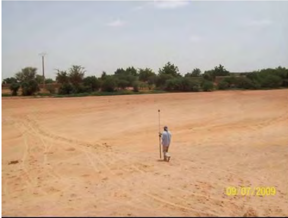
Photo 13: Suivi du profil topographique par la méthode d'implantation point par point du profil en travers N°3 sur le kori Boubon en juillet 2009
