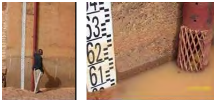
Photo 9: Echelle de crue et tube protégeant le flotteur d'un limnigraphe type Thalimedes OTT installées sous le pont du kori de Boubon depuis juin 2007
