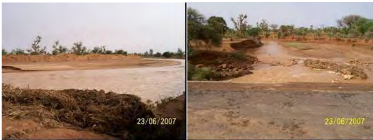
Photo 77: Suivis de l'érosion régressive des ravines secondaires à l'aide de piquets repères dans le bassin versant du kori Boubon en 2007 -2008 et 2009
