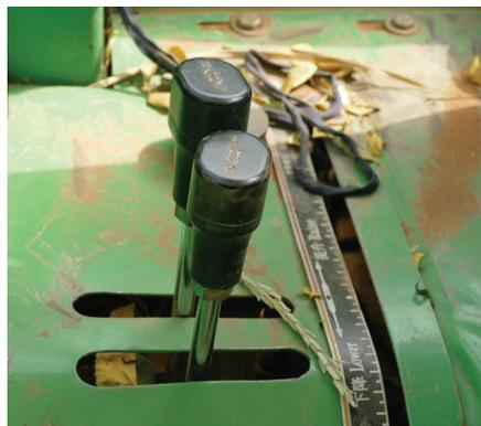
Positionner le levier en 4 roues motrices (4WD) **uniquement quand le tracteur est à l'arrêt.**
