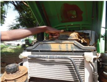
Vérifier le niveau quand le moteur est froid, sinon risques de brûlures.
