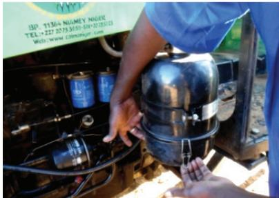
**Filtre à air démonté**
