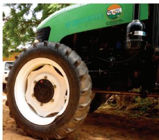
**Les roues directrices avant** assurent la direction du tracteur. Elles peuvent aussi se mettre en position 4 roues motrices.
