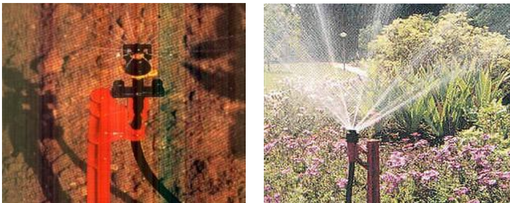
Image 8 : Micro-asperseur avec buse rotative (spinner)
