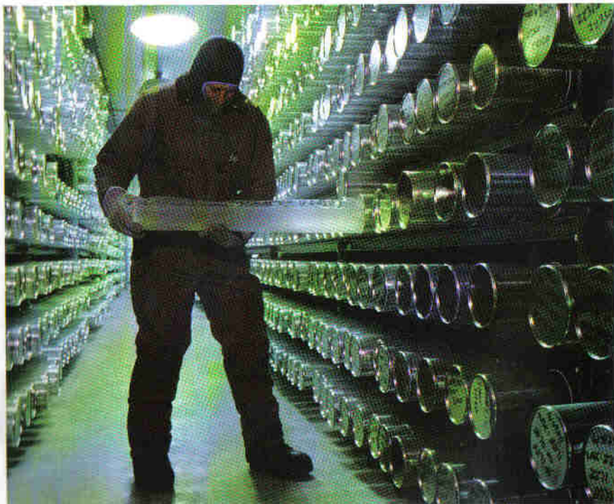
Q6 Piégées dans ces carottes de glace stockées à basse température, de minuscules bulles de l'atmosphère terrestre du passé révèlent la façon dont sa composition a varié dans le temps.
