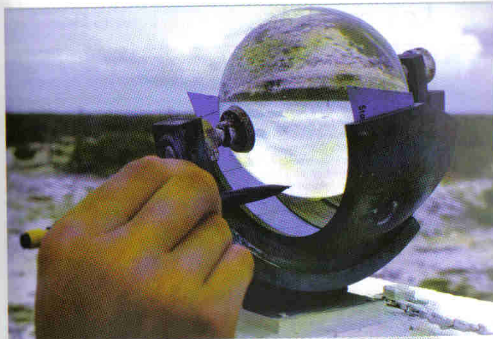
Sous une allure de boule de cristal, cet appareil sert à mesurer l'intensité du rayonnement solaire. L'objectif est bien de prédire l'avenir du climat...
