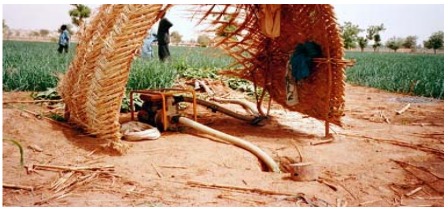
Système intensif avec motopompe et puisard (photo4)
