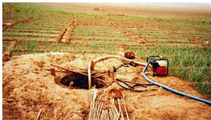
Système intensif avec motopompe et puisard (photo4)
