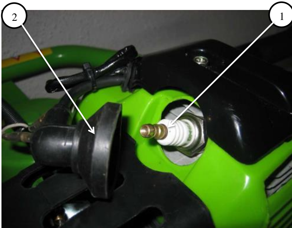
Image 18 : Contrôle de la bougie
