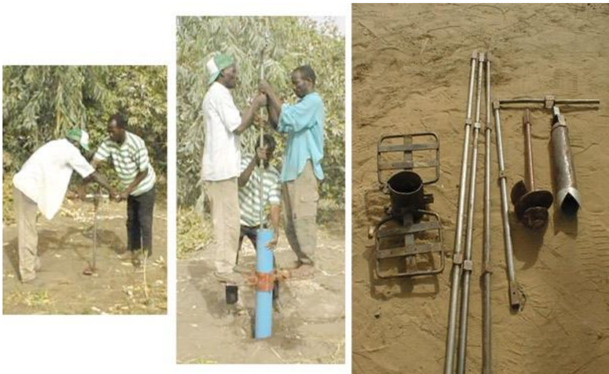
Image 1 : Foration à l'aide de la tarière manuelle et matériels de forage (Images PIP 2, 2002)
