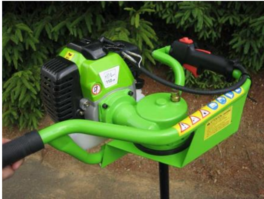
Image 11 : Mototarière avec les symboles de sécurité et d'informations
