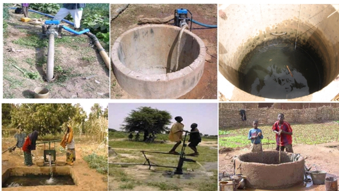
Figure 33 : Techniques de captage et d'exhaure à faible coûts, inventoriées dans le cadre de la petite irrigation privée. De gauche à droite : Forage manuel en PVC ; exhaure avec motopompe sur puits maraicher ; niveau d'eau dans un puits maraicher autour de mare de Tinga ; exhaure avec Pompe à la main, généralement utilisée par les femmes ; exhaure avec Pompe à pédale, exhaure avec puisette
