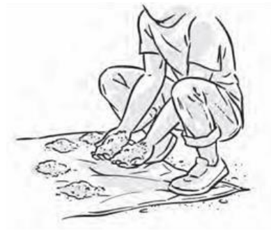
Image 69 : disposer tous les échantillons sur un morceau de plastique et de noter leur profondeur
