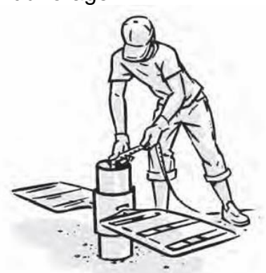
Image 72 : Mesurer la profondeur du forage
