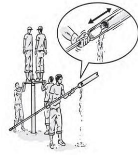
Image 66 : tenez la tarière en position verticale et secouez pour vider
