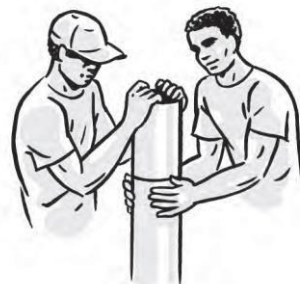
Image 54 : Vissez le capuchon de protection sur le pré-tubage afin d'éviter d'endommager les filetages
