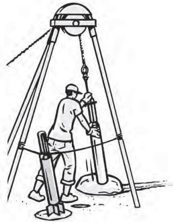
Image 115 : Demandez aux manœuvres de donner du moue sur la corde et placez la tarière sur une roche
