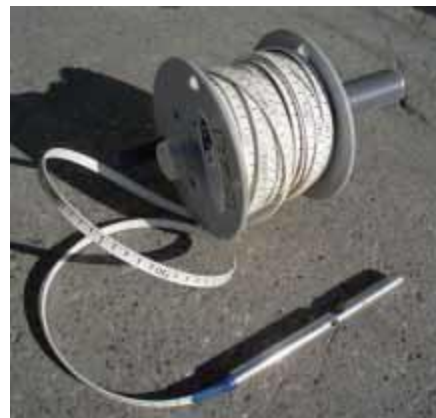
Image 243 : Sonde piézométrique électrique
