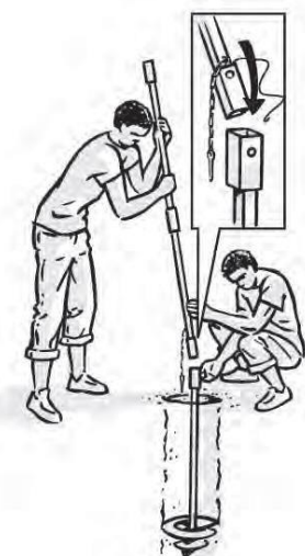
Image 45 : Couplage mal dans femelle
