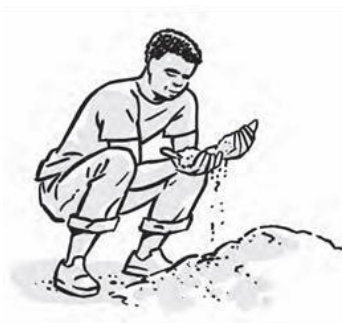
Image 68 : Prendre des échantillons de sol
