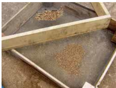
Image 8 : Le calibrage du massif filtrant
