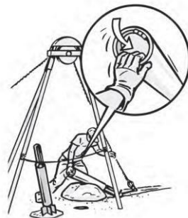
Image 116 : Faites pivoter le haut de la tarière.
