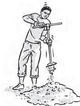
Image 44 : Secouez la tarière pour enlever les débris du sol
