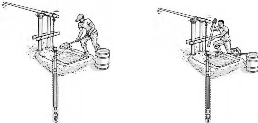
Image 179 : Evacuer les débris accumulés dans le bassin de décantation Image 180 : Ajouter une nouvelle allonge
