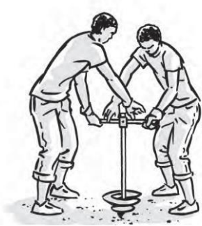
Image 39 : Place la tarière Conique sur le sol
