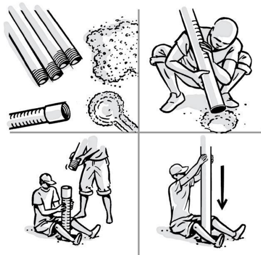
Image 187 : Installation du tuyau d'équipement en PVC
