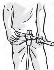
Image 36 : Avec Goupille fixez le couplage
