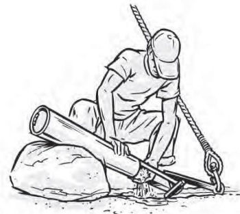
Image 118 : Prendre des échantillons de sol par-dessus la roche se poser sur le sol et ouvrez la valve de fond pour garantir la bonne évacuation des cuttings
