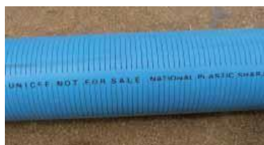
Image 5 : Tuyau crépine à l'usine
