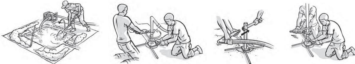
Image 231 : Curer les bassins de décantation Images 232 - 233 - 234 : Ajouter une allonge supplémentaire
