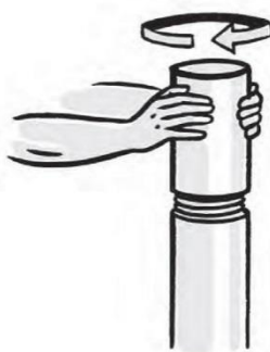
Image 54 : Vissez le capuchon de protection sur le pré-tubage afin d'éviter d'endommager les filetages
