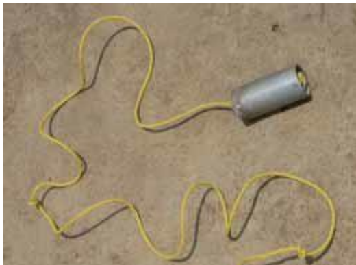
Image 244 : Instrument de mesure du niveau de l'eau
