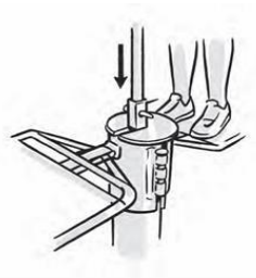
Image 61 : Laissez retomber la connexion sur la calle
