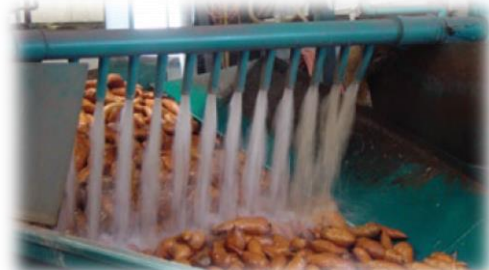
Rinçage à grande eau pour nettoyer les racines tubéreuses de patate douce
